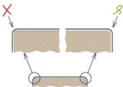
Figuur 5. Rond de randen af met minimaal R3, hierdoor dekt de verflaag in gelijke laagdikte. Bij een niet-afgeronde rand komt er nauwelijks verf op de scherpe rand
